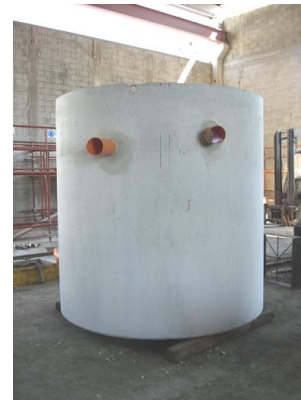
Vasche di contenimento
