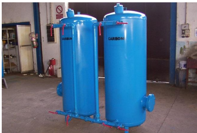
Stazione di filtrazione a sabbia e a carboni attivi
