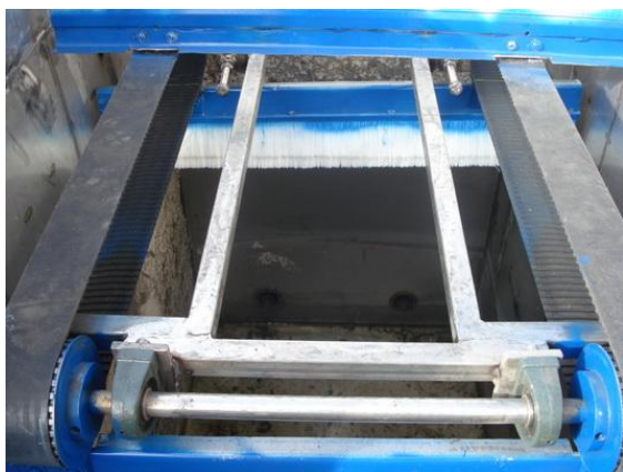
Comparto di separazione e scoltatura del fango
