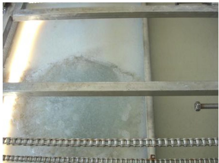
Nebulizzazione dell'aria nell'acqua di ricircolo
