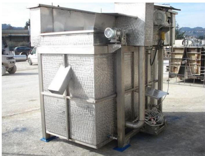
Canale di flocculazione e vasca di flottazione in soluzione monoblocco
