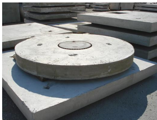
Vasca di contenimento e soletta di copertura
