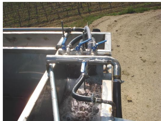
Distributore dell'aria fra i comparti
