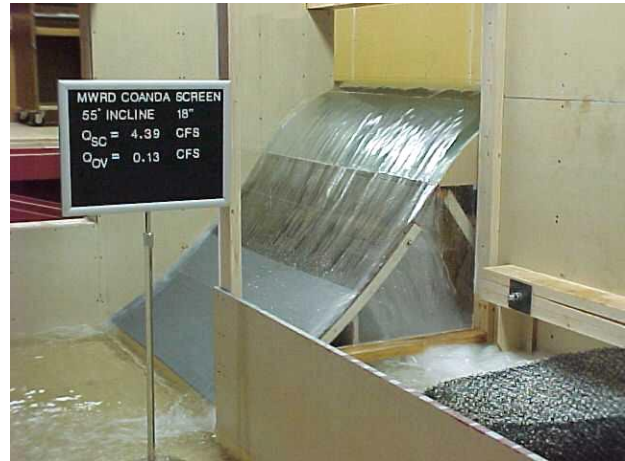
Laboratorio per prove sperimentali sull'effetto Coanda
